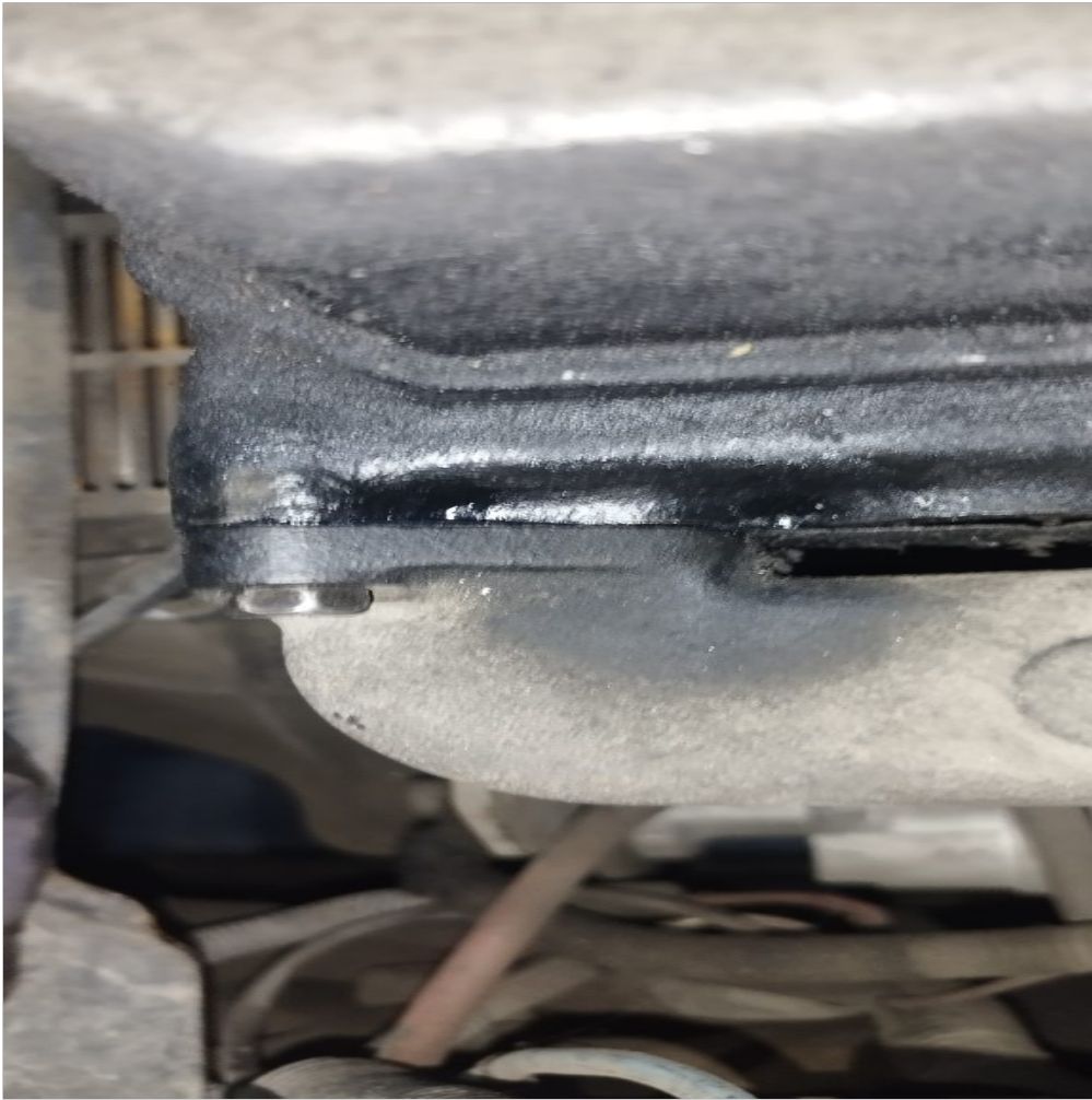
Fuga de escape por múltiple de escape
