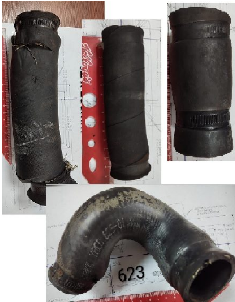
Mangueras en mal estado
