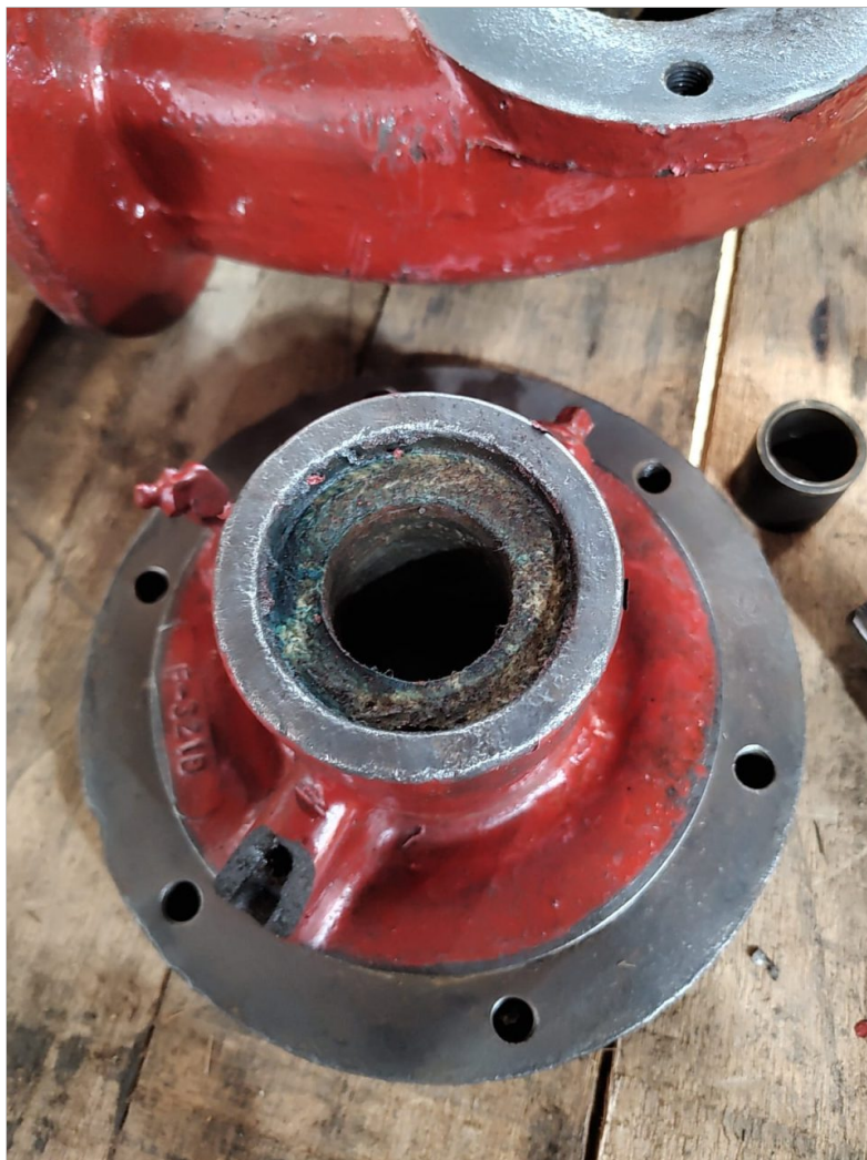
Se reparo conexión partida
