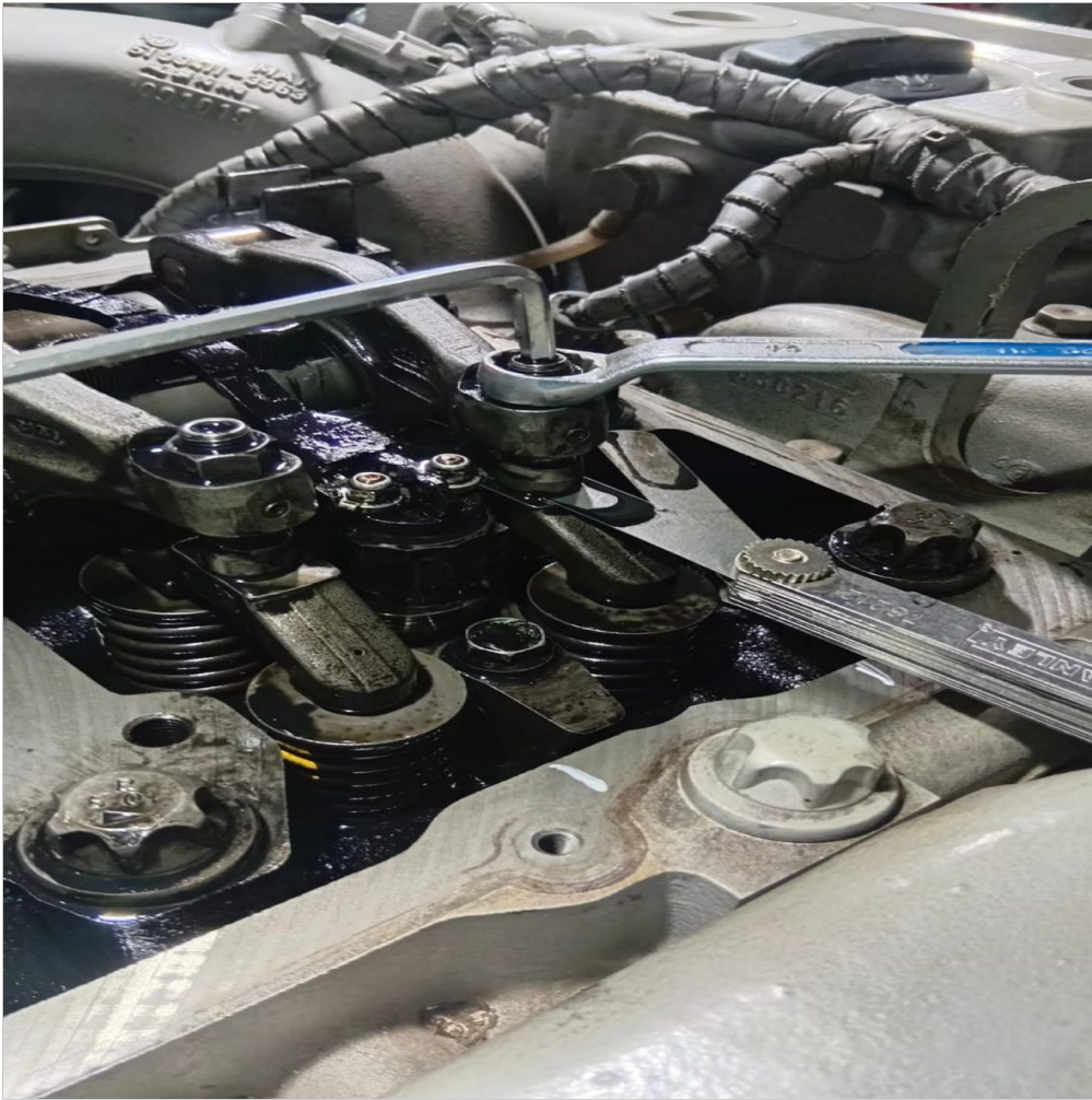
regulacion de valvulas motor
