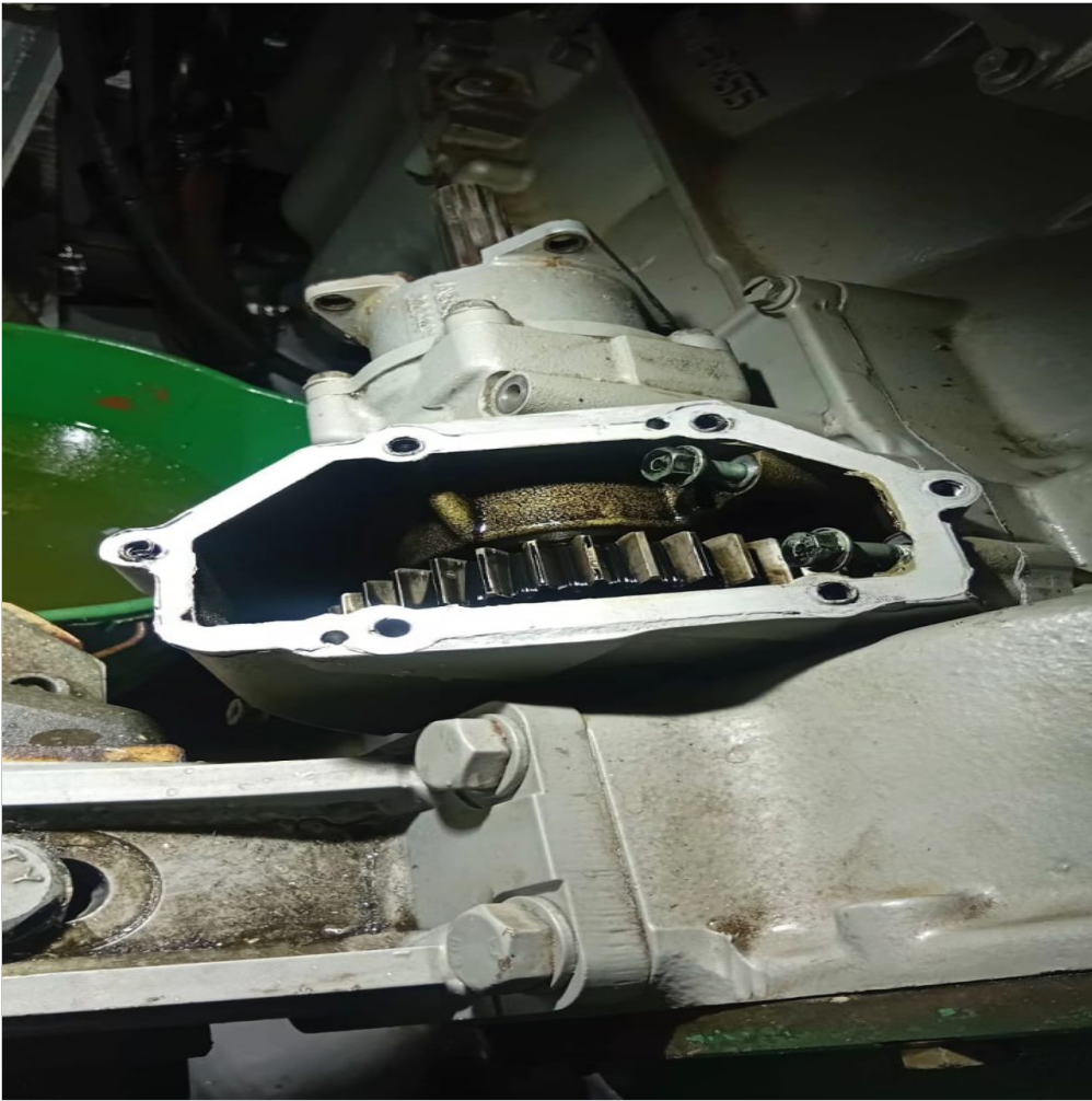
revisión y corrección en fuga de aceite por mando bomba de agua mar
