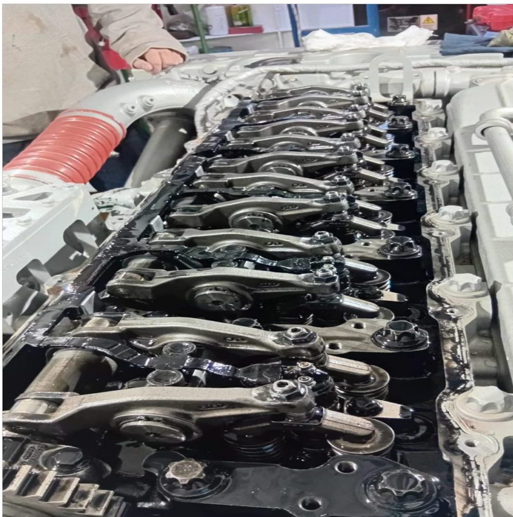
prueba y ajuste de valvulas
