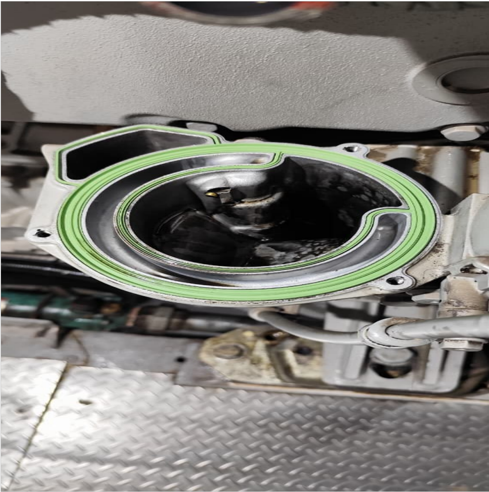
montaje de centrifugo
