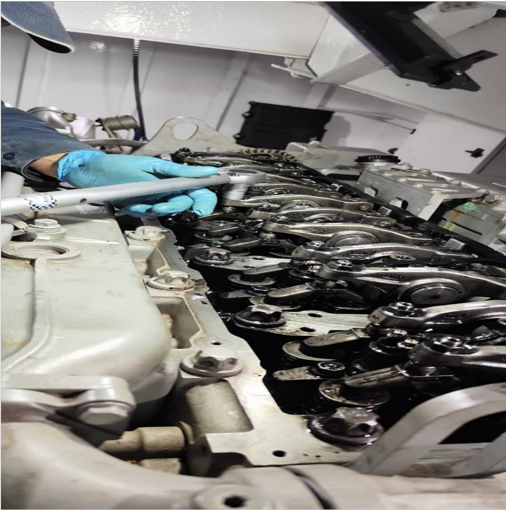
prueba y ajuste de valvulas motor
