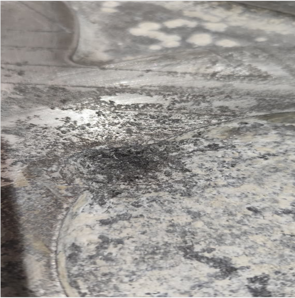
tapa frontal de enfriador de placas dañado
