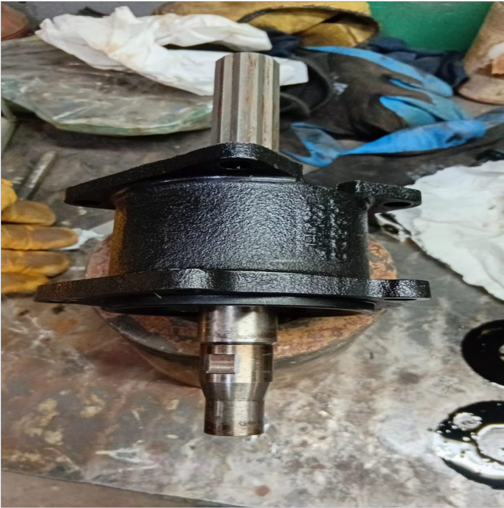
rodamiento nuevo de bomba de agua mar
