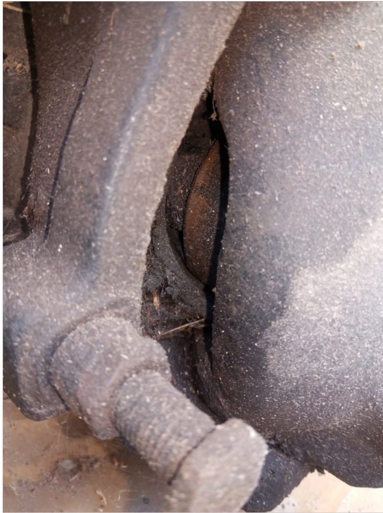
fuga aceite en reten cañonera diferencial
