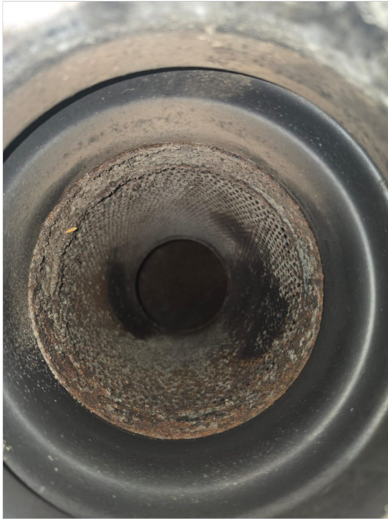
Filtro de aire en mal estado
