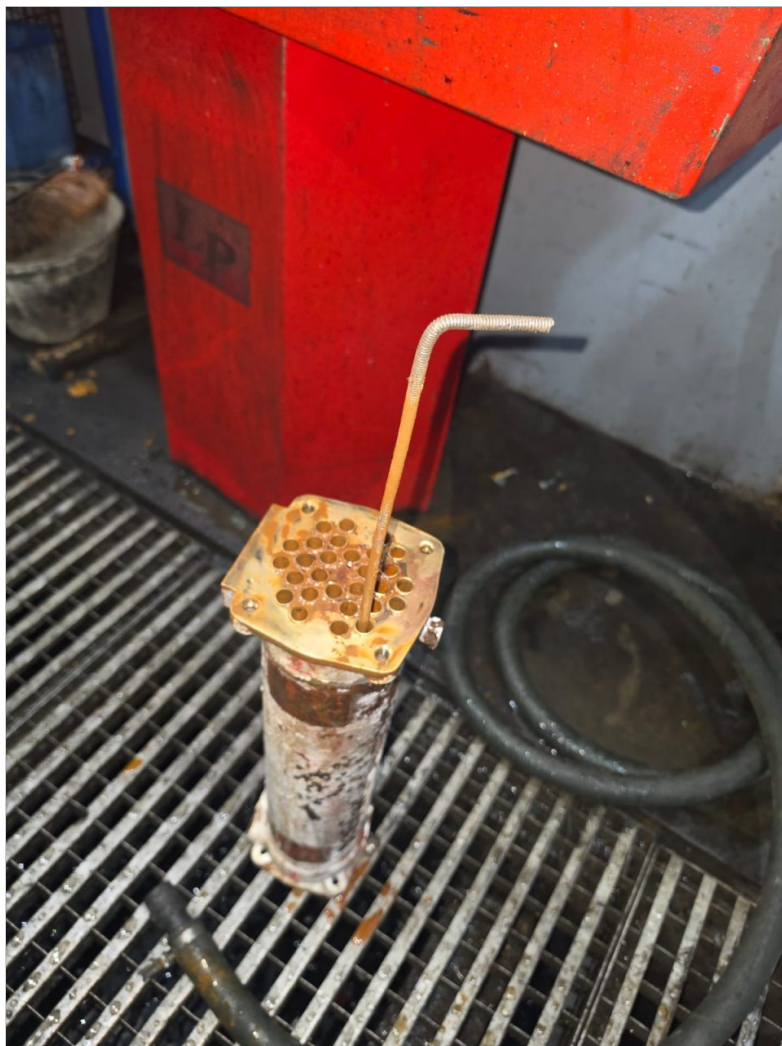
Limpieza de enfriador de transmision en taller
