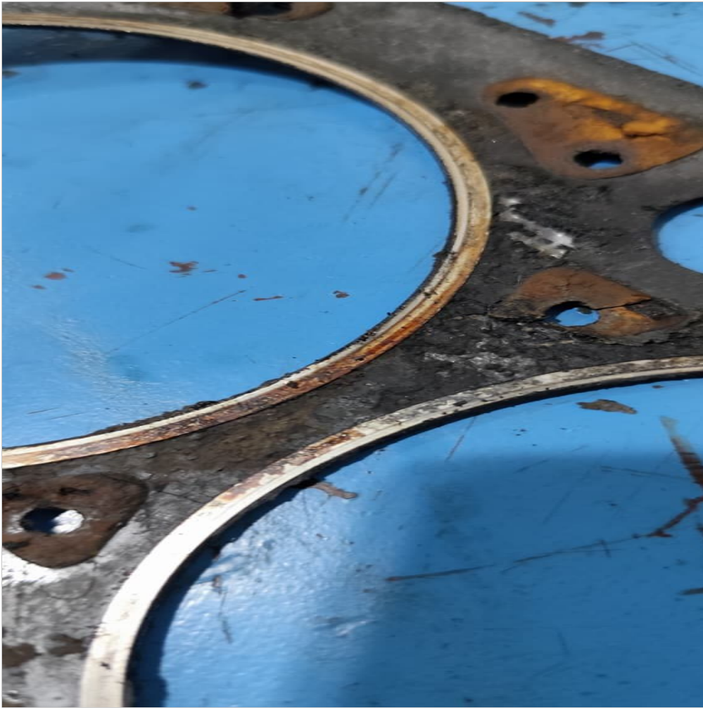
junta tapa cilindro deteriorada
