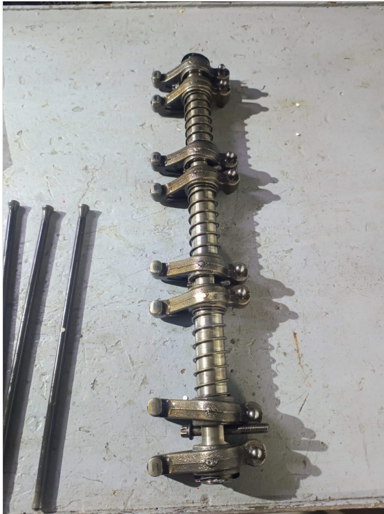
Control de la flauta de valancines
