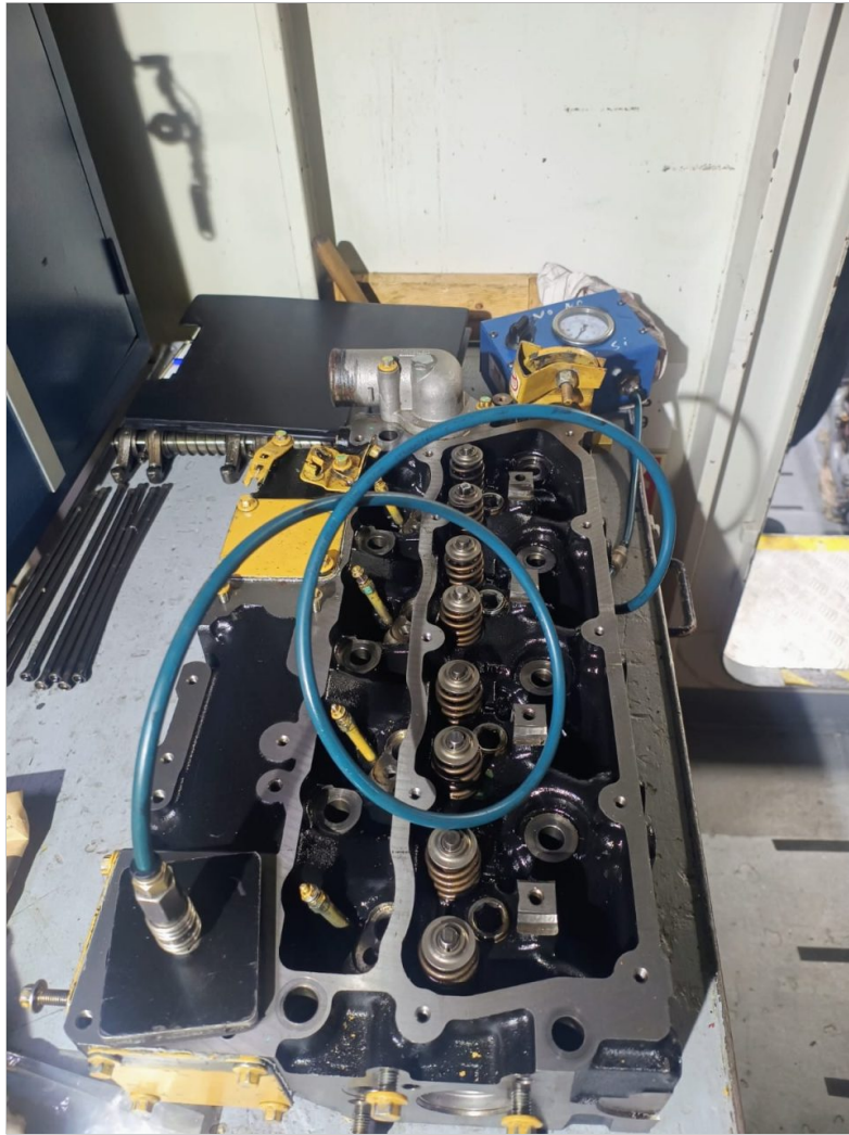
Se realiza prueba de estanqueidad (vacío)
