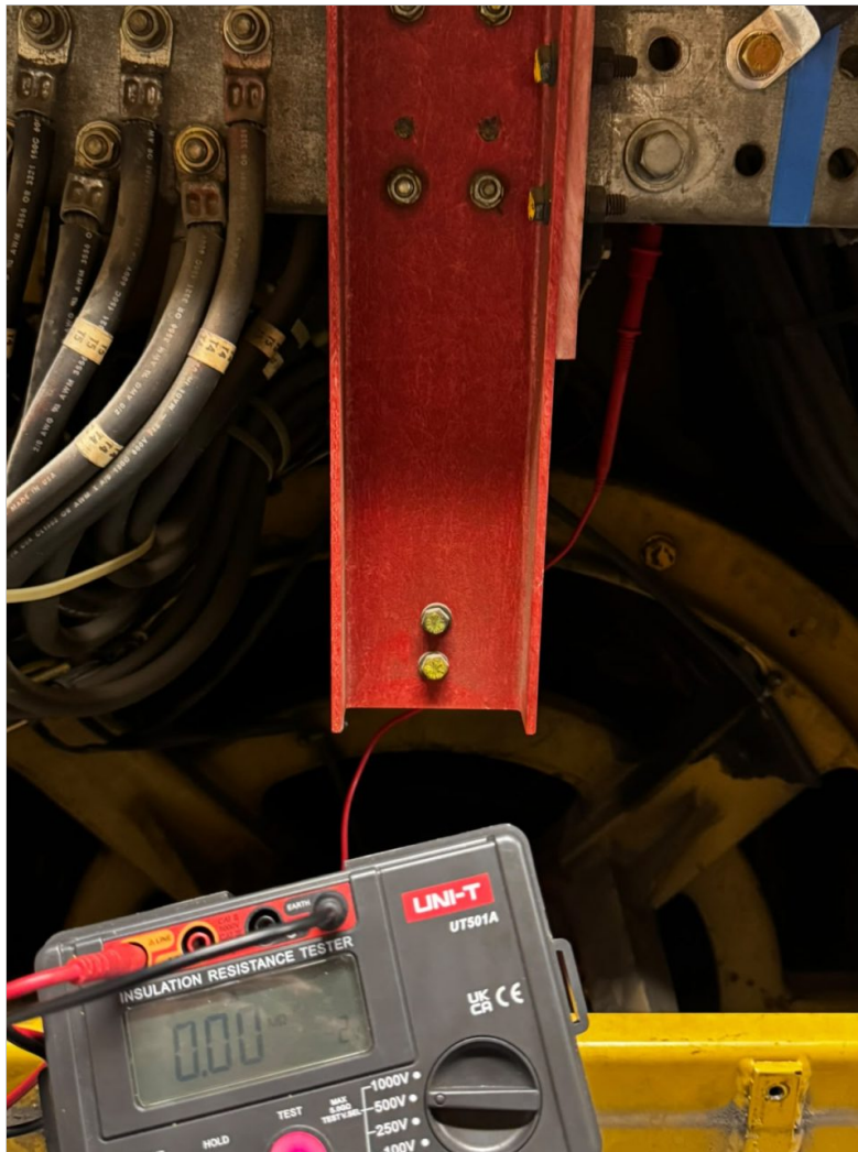
Megado entre chasis de motor - estator principal
