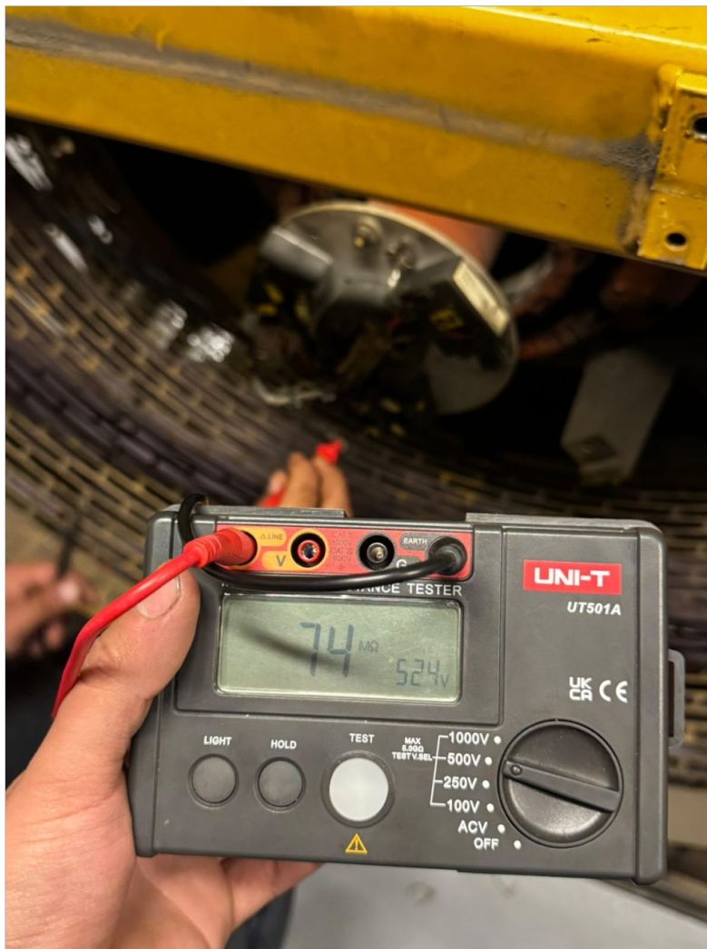
Megado entre rotor principal - contra chasis de motor
