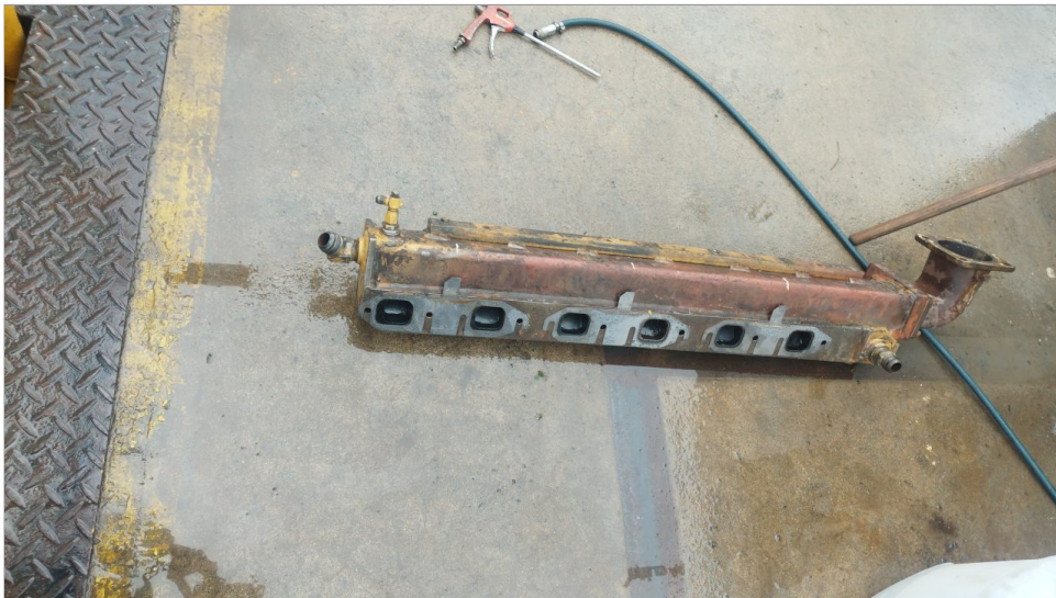
Desmontaje de múltiple y prueba
