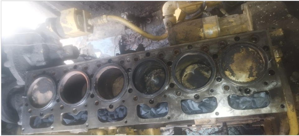
Desmontaje de culata, limpieza y descarbonizacion
