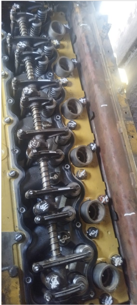
Montaje y regulación de calvulas
