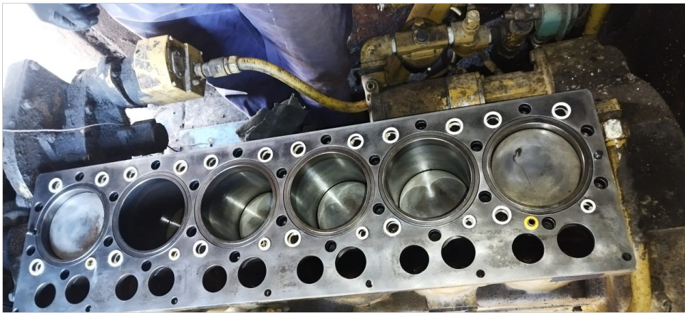
Preparativos para el montaje de la culata
