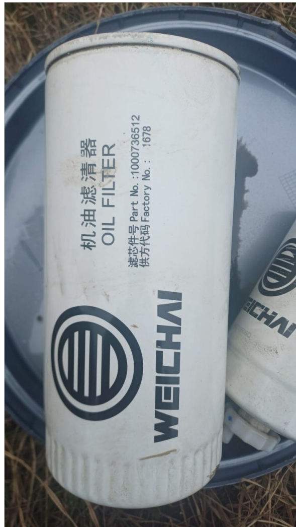
filtro aceite original puesto en maquina
