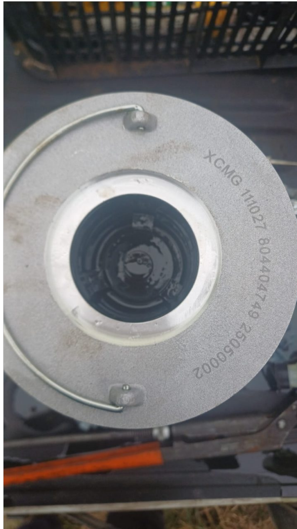
filtro retorno aceite hidráulico puesto en equipo (correcto).
