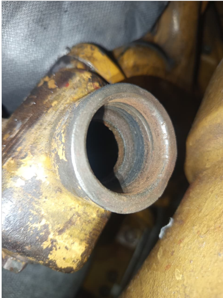
Reparacion preventiva en pérdida de refrigerante proveniente en línea de retorno de turbos.
