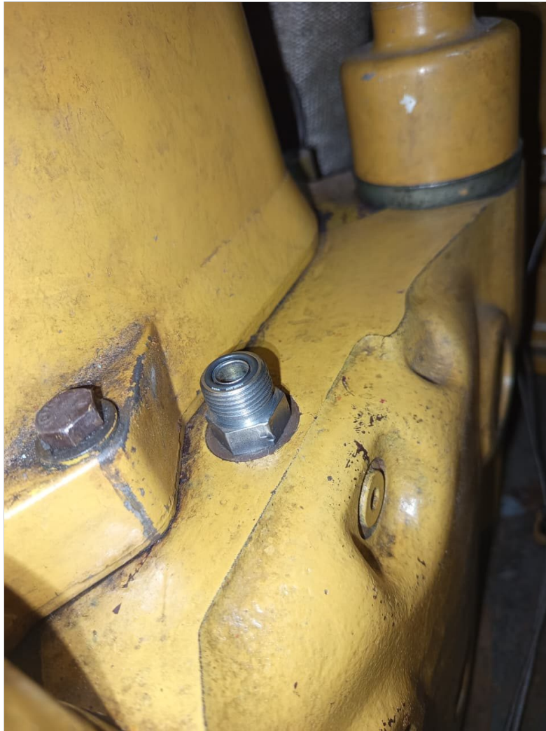
Cambio de conector y sellos en línea de combustible por pérdida de fluidos.
