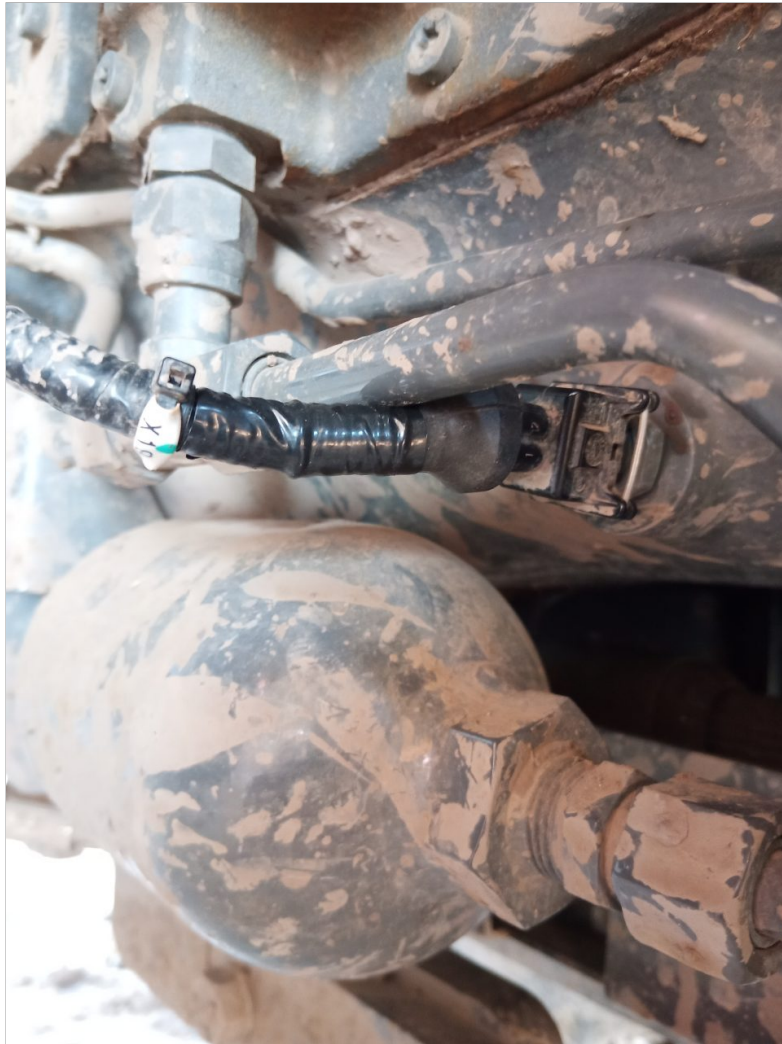
Reparacion arnes de sensor
