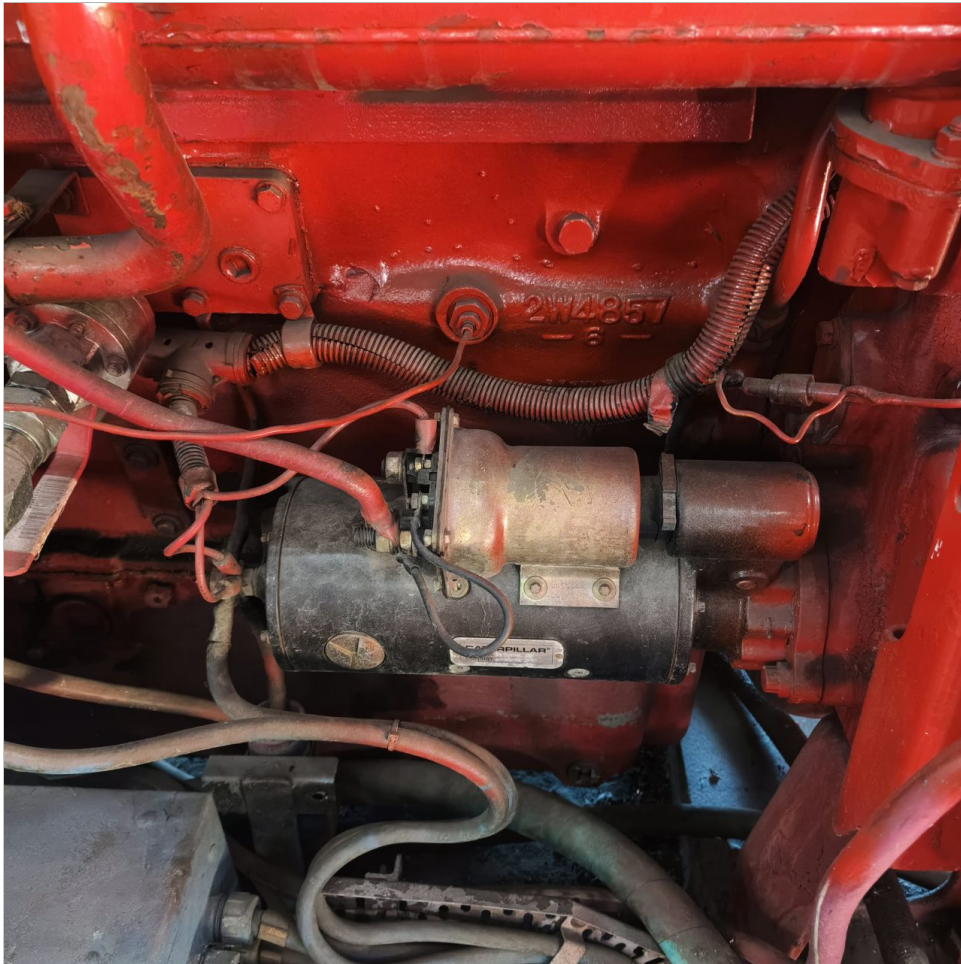
Circuito electrico arranque
