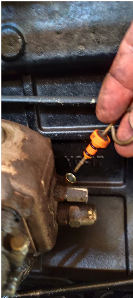
bajo nivel aceite de mando bomba inyectora
