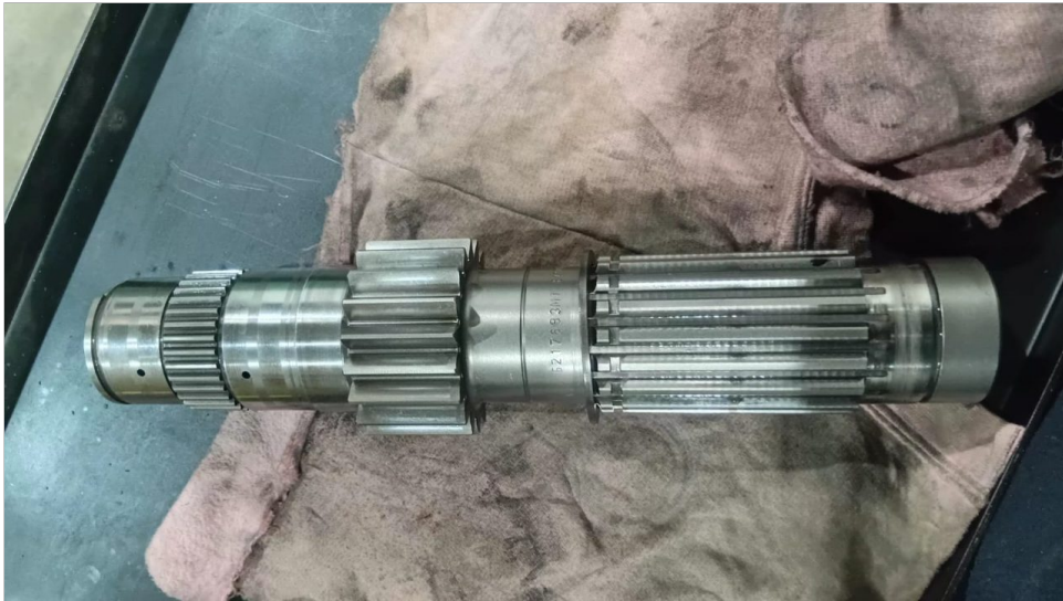
EJE ENTRADA DAÑADO
