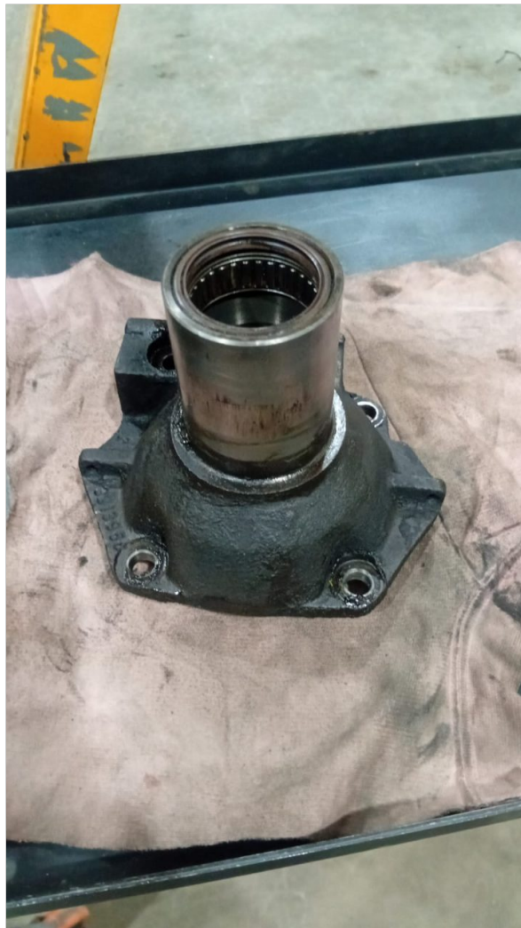
BOTELLA PORTA RODAMIENTO DE ENTRADA DAÑADO
