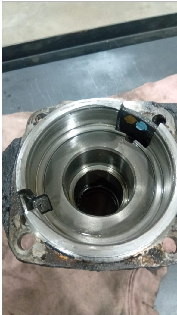
PORTA RODAMIENTO DAÑADO
