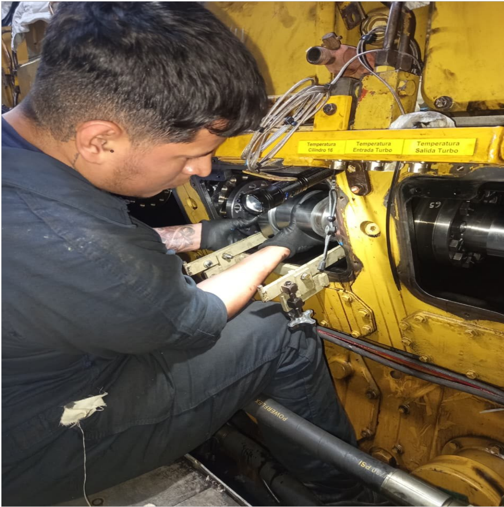
Extracción de levas originales del motor.
