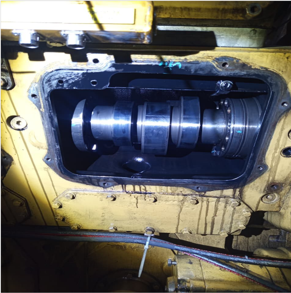
Extracción de levas originales del motor.
