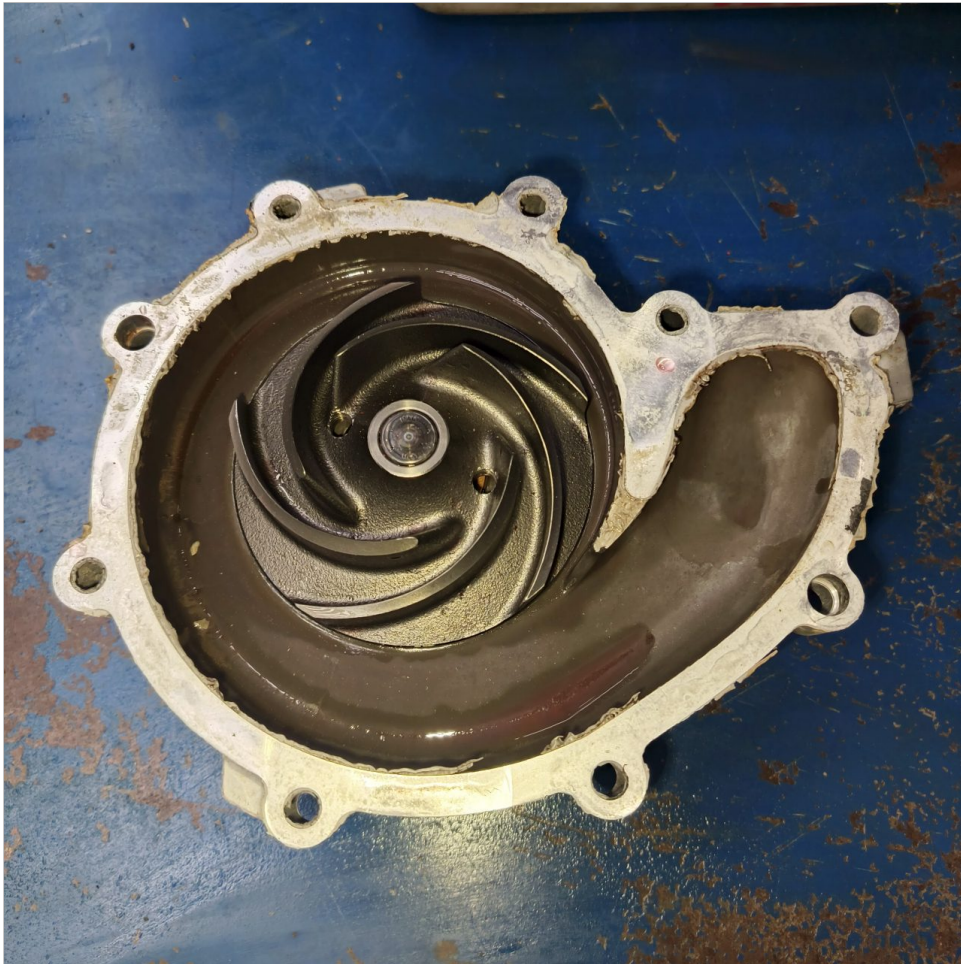
Bomba de agua - Desmontaje 2
