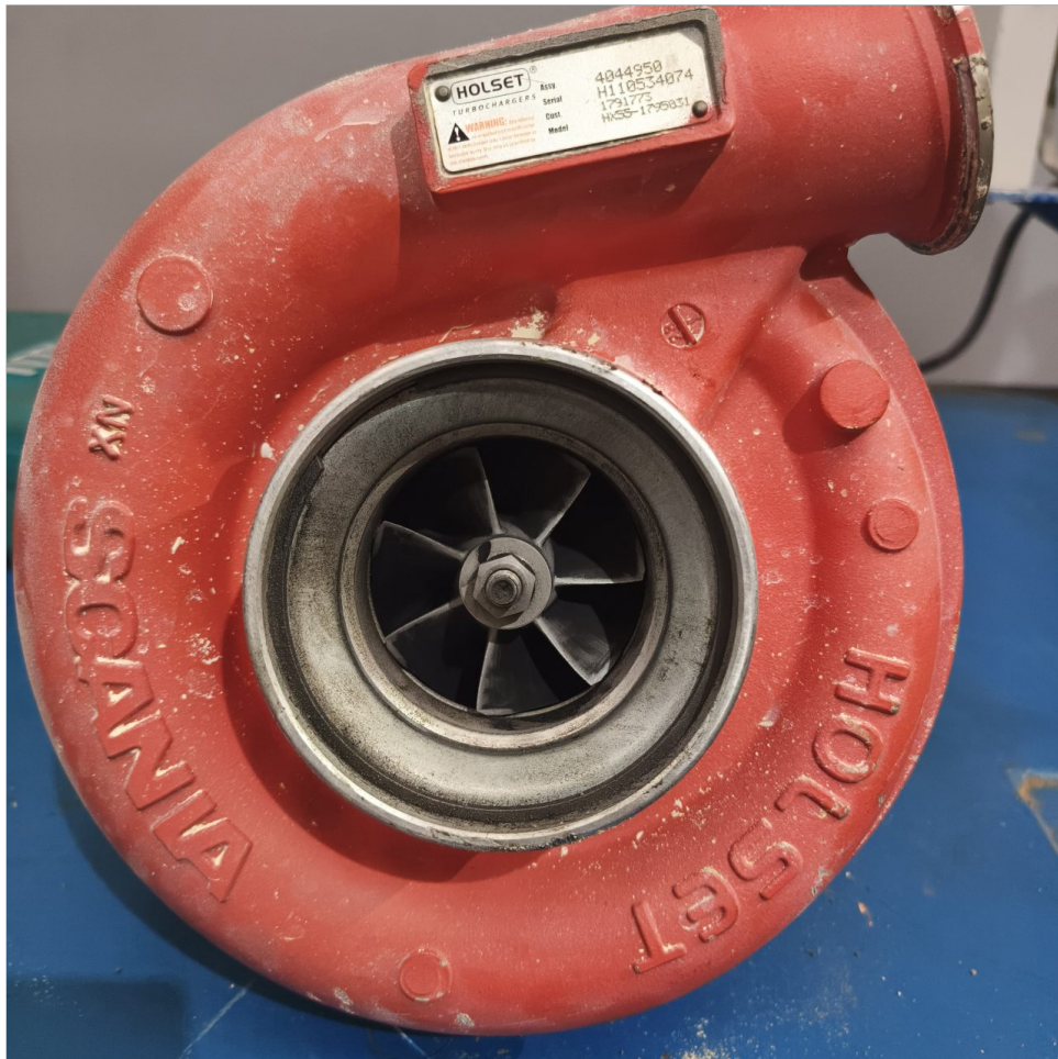
Turbo - Estado inicial compresor
