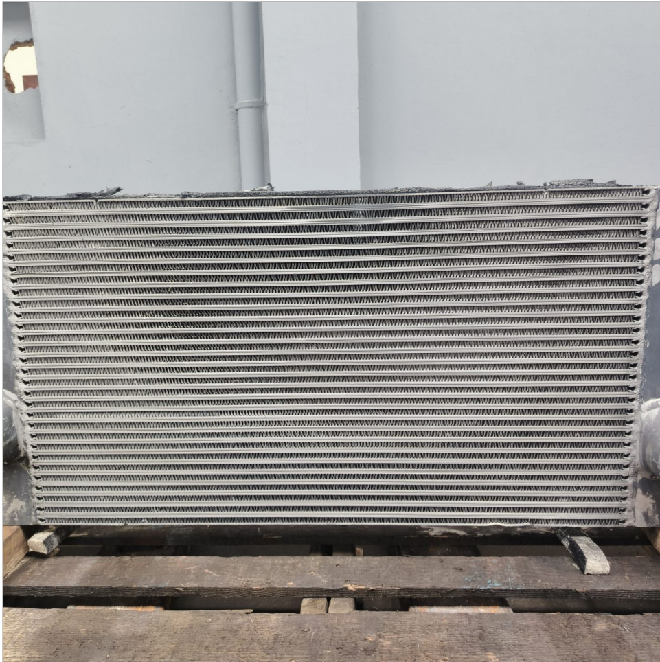
Radiador - intercooler pos limpieza
