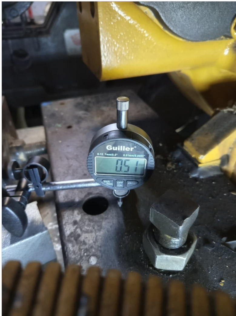
Motor Principal Cat 3516 Estribor. - Control de alineación.
